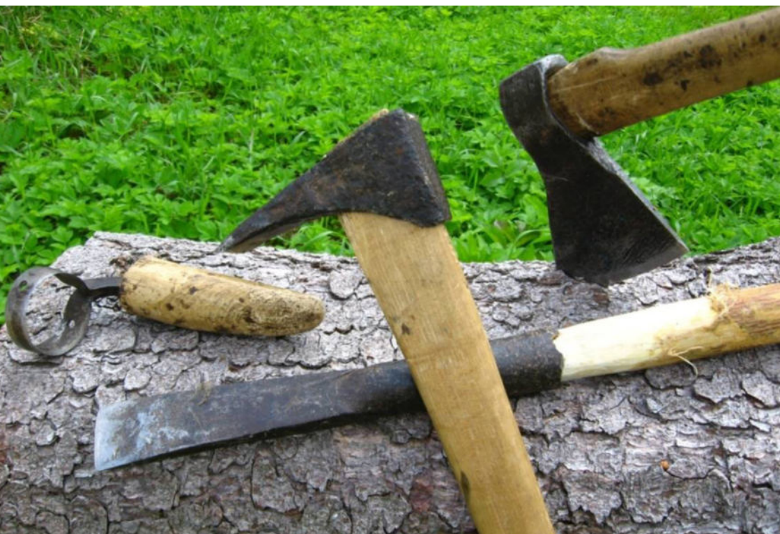
Na zdjęciu od lewej: do prawej skobliczka, cieślca i siekiera; wzdłuż piesznia (fot. J. Adamczewski)
